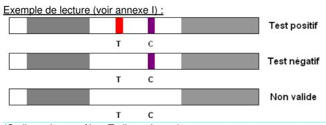
(C : ligne de contrôle – T : ligne de test)
