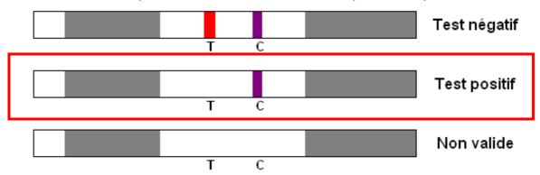
(C : ligne de contrôle – T : ligne de test)
